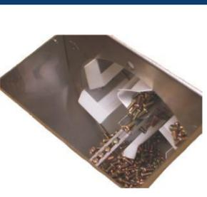
回転ドラムと水平振動レールで確実に搬送。ゴミなどによるレールの目詰まりを防止。
